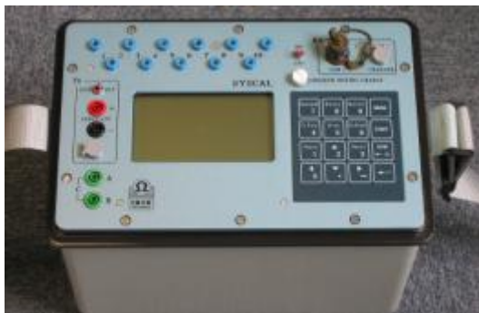
Σχήμα 2.7. Το γεωηλεκτρικό όργανο SYSCAL-Pro της εταιρείας IRIS INSTRUMENTS που χρησιμοποιήθηκε για τη λήψη των μετρήσεων. (αριστερά). Ο εξοπλισμός με τη συνδεσμολογία που χρησιμοποιήθηκε κατά τη διάρκεια της μέτρησης (δεξιά).
