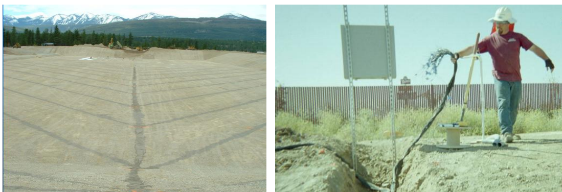
Σχήμα 2.14 Μόνιμα δίκτυα γεωηλεκτρικής παρακολούθησης σε ΧΥΤΑ. (από Darilek, 2007).
