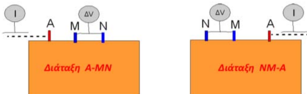
Σχήμα 2.3. Οι δυο διαμορφώσεις της διάταξης πόλου-διπόλου
