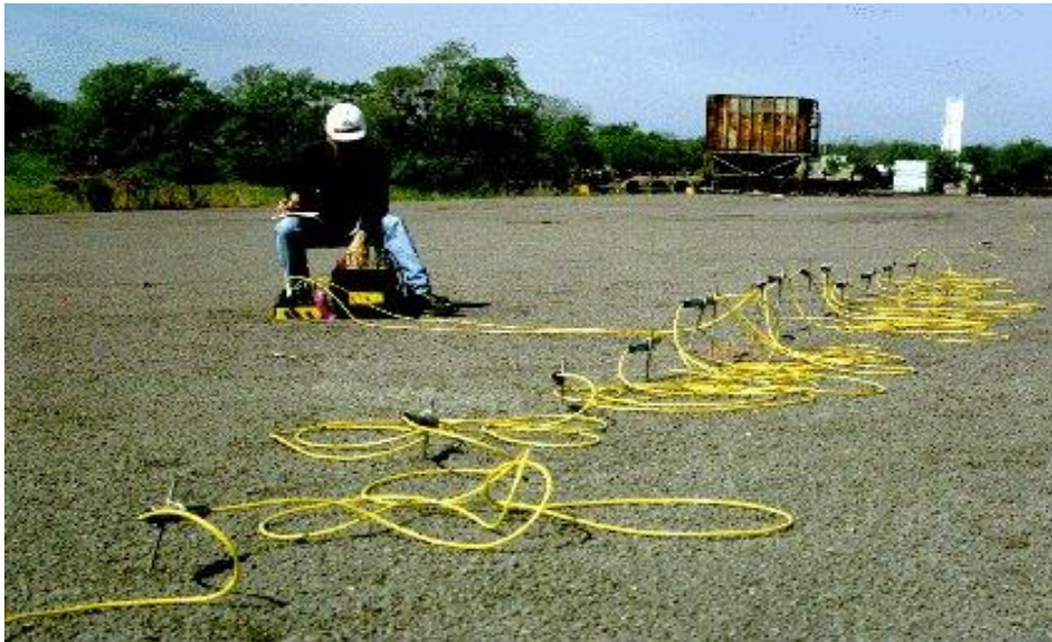
Σχήμα 2.5. Πολυκάναλο σύστημα λήψης μετρήσεων ηλεκτρικής τομογραφίας
