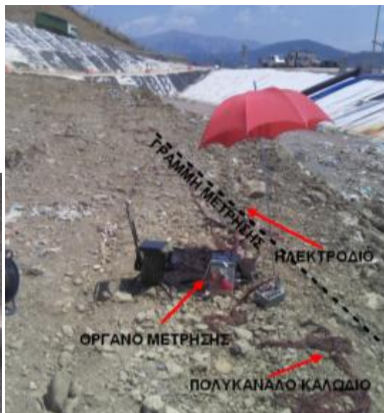
Σχήμα 2.7. Το γεωηλεκτρικό όργανο SYSCAL-Pro της εταιρείας IRIS INSTRUMENTS που χρησιμοποιήθηκε για τη λήψη των μετρήσεων. (αριστερά). Ο εξοπλισμός με τη συνδεσμολογία που χρησιμοποιήθηκε κατά τη διάρκεια της μέτρησης (δεξιά).
