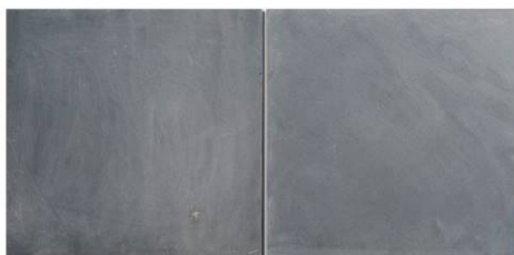
Φωτ. 5.2.7: Σχιστόπλακες ορθογωνικής κοπής ελάχιστου πλάτους 50cm.
