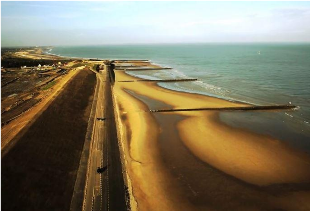
Εικόνα 7: Πρόβολοι κατά μήκος της ακτογραμμής ( www.dredgingtoday.com ).
