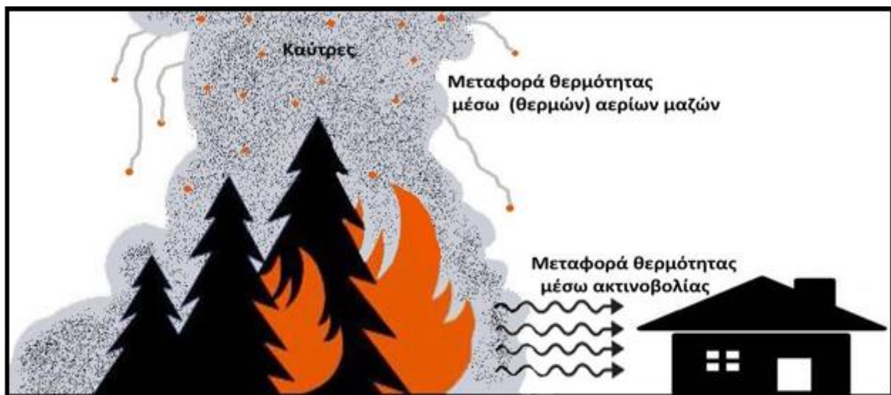
Εικόνα 2. Τρόποι ροής της θερμότητας σε μια δασική πυρκαγιά, που εξελίσσεται πλησίον κτιρίου και απεικόνιση πιθανού τρόπου μετάδοσης δασικής πυρκαγιάς με μεταφερόμενες καύτρες σε κτίρια χωρίς την παρουσία ανέμου υπό συνθήκες πρόσκαιρης νηνεμίας, ή ατμοσφαιρικής ευστάθειας.
