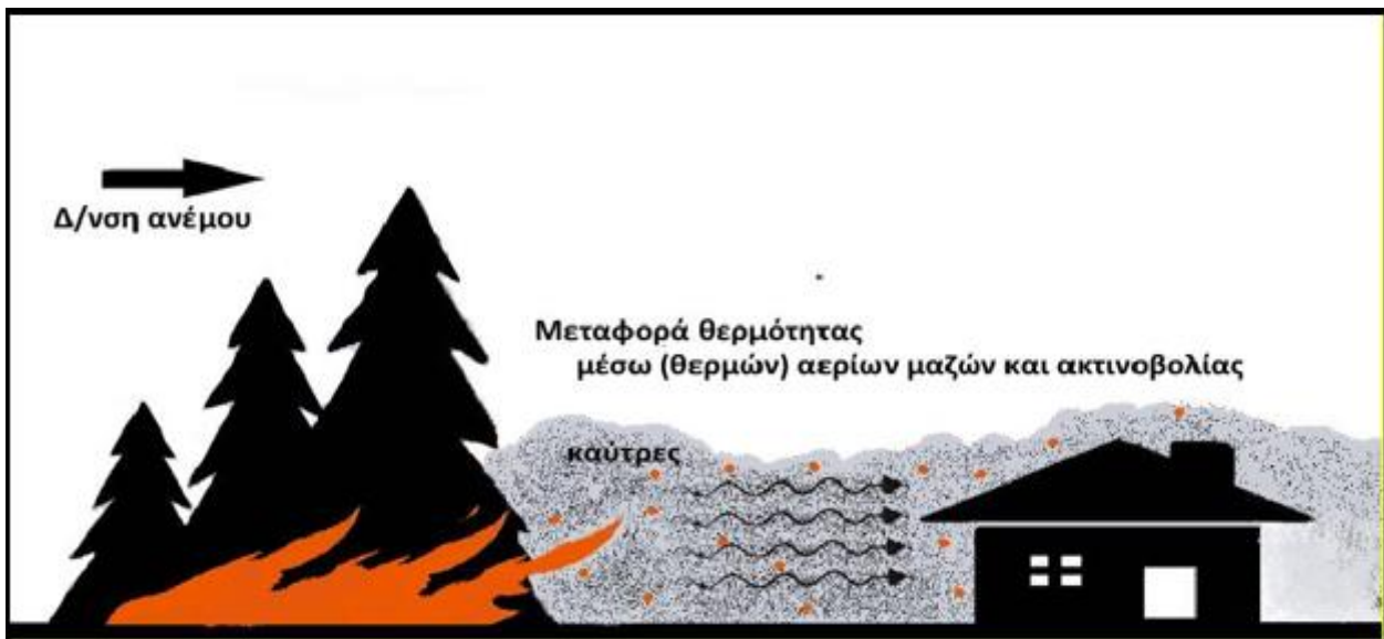
Εικόνα 4. Τρόποι ροής της θερμότητας σε μια δασική πυρκαγιά, που εξελίσσεται πλησίον κτιρίου και απεικόνιση πιθανού τρόπου μετάδοσης δασικής πυρκαγιάς με μεταφερόμενες καύτρες σε κτίρια παρουσία ισχυρού ανέμου.
