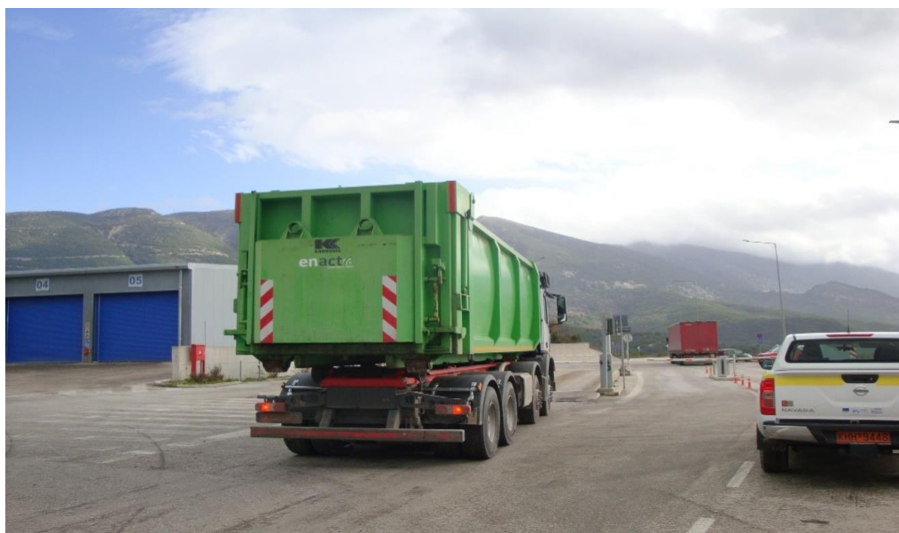
Εικόνα 15: Στεγανή πόρτα απορριματοκιβωτίου τύπου container
