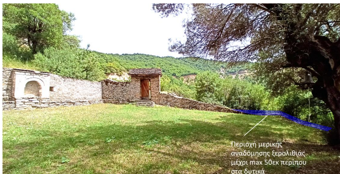
Εικ. Β18. Η διάταξη και η γεωμετρία του νότιου τοίχου από ξερολιθιά που θα διατηρηθεί με μια μικρή αναδομείς της τάξης των 50εκ. δυτικά για την οριοθέτηση του χώρου. Παρόμοια τελική μορφή προτείνεται και στη βόρεια πλευρά του αυλόγυρου.
