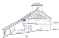
Προσεγγιστική απεικόνιση της προσθήκης – αναδόμησης λιθοδομής στην ανατολική πλευρά του χαγιατιού.
